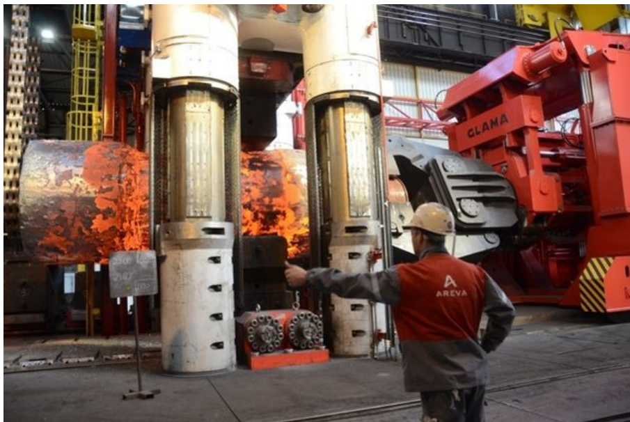
Figure 1.2 – Lingot en cours de forgeage.
