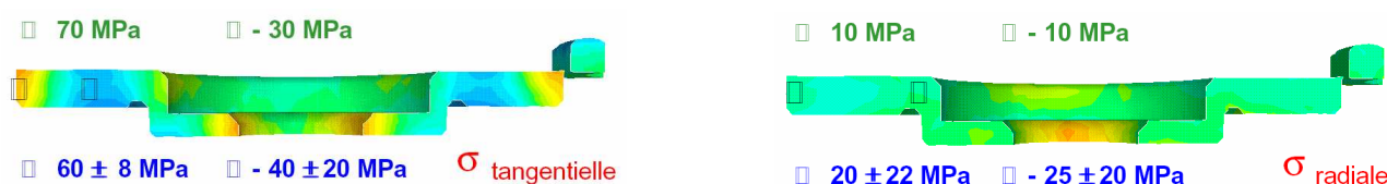
Figure 20. Etat de contraintes dans un disque plein, en fonte, suivant une coupe de plan vertical. Ligne du haut (en vert) : valeurs prédites par le calcul. Ligne du bas (en bleu) : valeurs mesurées.
